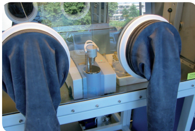
図1. グローブボックス内に設置されたPlatinum ATR付ALPHAスペクトロメータ
